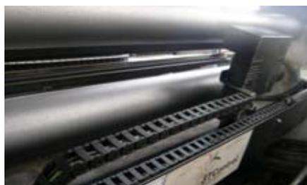
Le système IPA traverse la bande de part en part et contrôle divers paramètres à l'aide du même système de caméra.
