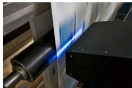
Mit einer Messbreite von 160 mm werden mehrere Farbzonen gleichzeitig gescannt.
