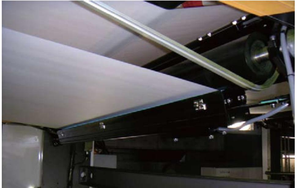
Beim Scannen der Bahn werden die Istwerte erfasst. Als Referenz werden Vorstufendaten herangezogen.
