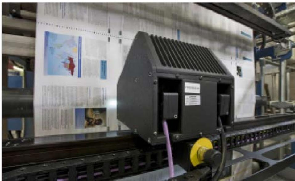
Colorscan erlaubt die Messung direkt im Bild, wobei mehrere Farbzonen auf einmal gescannt und ausgewertet werden.
