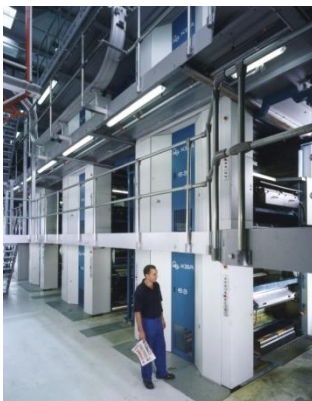
Mediaprint produziert auf insgesamt 13 KBA Commander-Rotationen, die in einem umfangreichen Retrofit-Programm modernisiert werden
