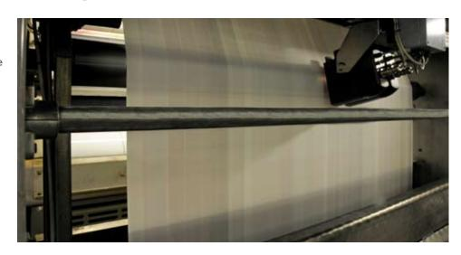
Loop est un système de contrôle des couleurs entièrement automatique pour les rotatives de presse qui fonctionne sans aucun repère. Il permet d'obtenir, de manière constante, un haut niveau de qualité des couleurs et de réduire le taux de gâche et la consommation d'encre.
