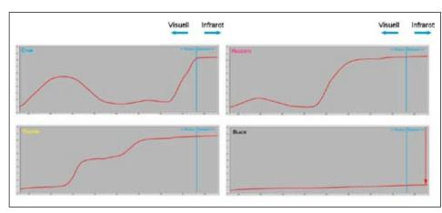
Grâce à la plage infrarouge, Loop peut déterminer les différentes proportions CMJN.
