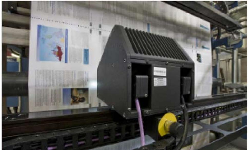
Colorscan permet de mesurer directement dans l'image. Plusieurs zones d'encrage sont balayées par la caméra et évaluées en même temps.
