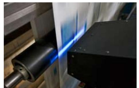
Plusieurs zones sont balayées en même temps avec une largeur de mesure de 160 mm.
