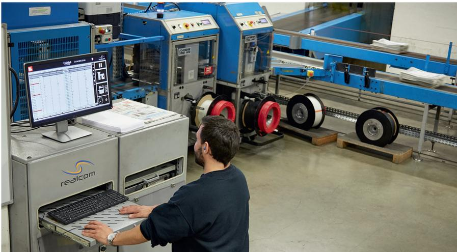
Der Versandraumleiter plant die Produktion am zentralen Leitstand und teilt die Routen den drei Linien zu. Per Drag&Drop kann er Produktionen zwischen den Linien verschieben.
