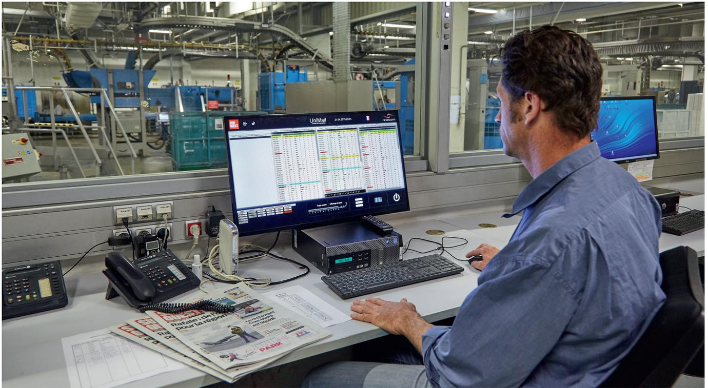
Der Versandraumleiter plant die Produktion am zentralen UniMail-Leitstand und teilt die Routen den drei Linien zu. Per Drag&Drop kann er Produktionen einfach zwischen den Linien verschieben.
