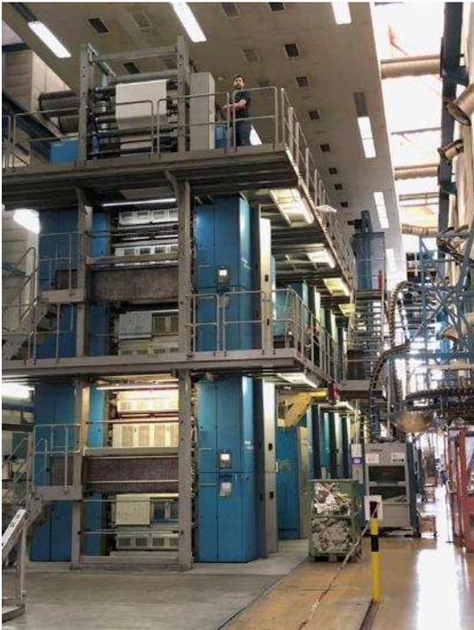
Die «Wifag evolution 371»-Druckmaschine bei Centre d'Impression Lausanne
