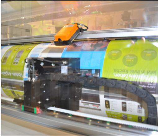
Die neue Colorman e:line für den Allgäuer Zeitungsverlag wird mit dem Farbgelssystem IDS (alle 4 Bahnen) sowie dem System mRC+ für die automatische Regelung des Farb- und Schnittregisters (36 Kameras) von Q.I. Press Controls ausgestattet. Auch die erste Goss Colorliner CPS für DC Thomson erhält mRC+-Regelsysteme für Farb- und Schnittregister.
