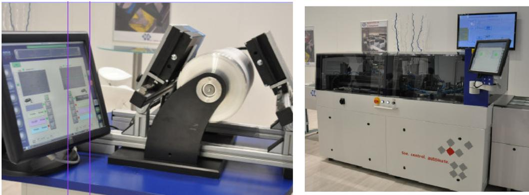
Eine drupa-Neuheit ist das Registerstanz- und Biegesystem **VCPEvolution HS 800** für Einzel- und Panoramaplatten mit optischer Ausrichtung (Video Control Positioning). Es zeichnet sich durch eine hohe Durchsatzgeschwindigkeit von über 420 Druckplatten pro Stunde aus. Die Abkantung erfolgt nach kundenspezifischen Vorgaben.
