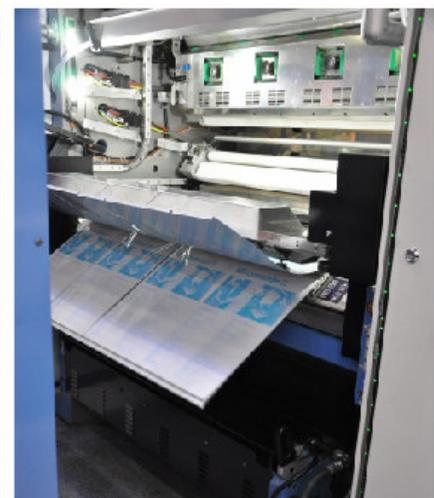
**Von links: Die neuen Platten werden an der Druckeinheit bereitgestellt; das Plattenwechslergerät nimmt die alten Platten ab (je 4 auf einmal) und legt sie auf einem Gestell ab, das dann weggeklappt wird; die neuen Platten werden nacheinander erst auf den oberen und dann auf den unteren Zylinder aufgelegt.**
