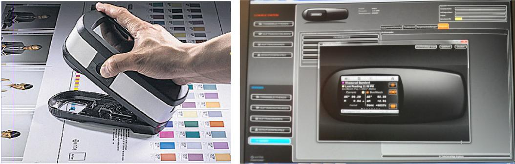
Neu sind auch i1Pro 2-Farbmanagementlösungen einschließlich des erweiterten **Spektralphotometers i1Pro 2**, das eine höhere Genauigkeit, Vielseitigkeit, Ergonomie und Funktionalität bietet als das i1Pro. In Verbindung mit dem jüngsten Release v1.3 der i1Profiler-Software erfüllt das neue i1Pro 2-Portfolio die Anforderungen von Druckvorstufe, Digitaldruck und professionellen Fotografen.
