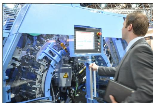
Die zweite Produktneuheit ist **FlexPack**, eine kompakte Paketbildungs- und Verpackungslinie, die für die Verarbeitung von beilagen-intensiven, stark regionalisierten Produkten entwickelt wurde. FlexPack vereint eine Reihe von Funktionen in einer Maschine: die schonende Stapelbildung, die Zuführung von Unterbogen und Deckblatt (inklusive Beschriftung) und die Paketumreifung mit zwei parallelen Kunststoffbändern in einem Vorgang – und das alles auf kleinem Raum.
